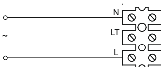
Schéma zapojení ventilátoru s časovačem, s časovačem a senzorem vlhkosti a s vestavěným spínačem Obr. 4.3
